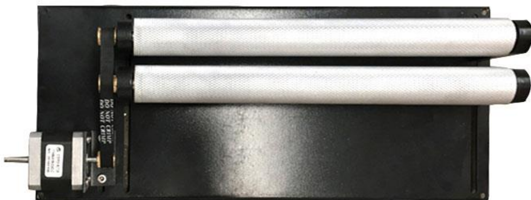
图 6-7-11 旋转雕刻切割示例图—滚轮式
